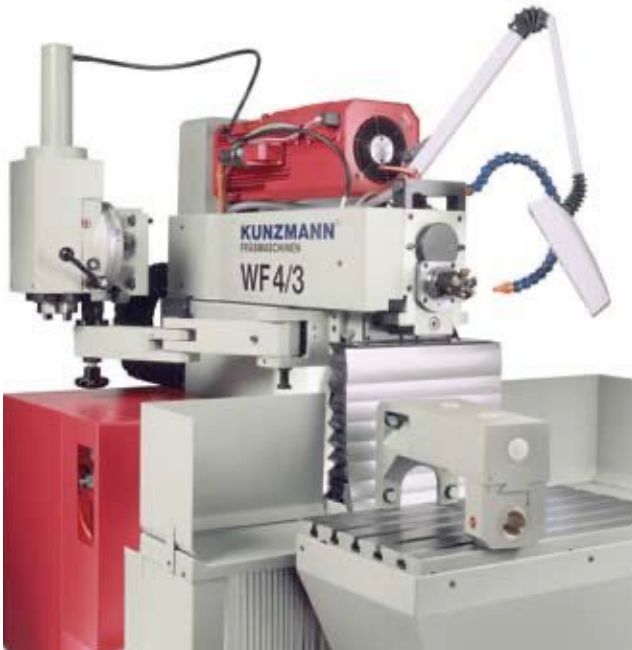
Horizontale Bearbeitung mit oder ohne Gegenhalter
